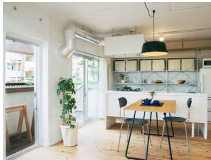
完全に壁から離れたアイランドキッチンも1階だからこその特徴です。床下を自由に使えるので、排水位置を気にせずキッチンを設置できました。
