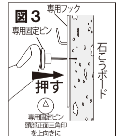
専用固定ピン頭部(正三角印)を上向きに
