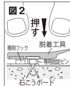
専用固定ピンの先端は石こうボードの中で開く仕様になっております。
