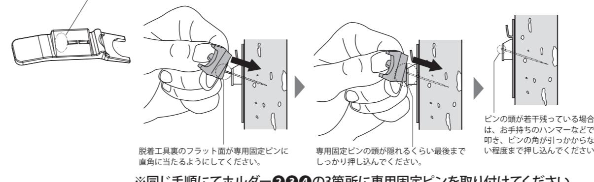
3 脱着工具③のフラット面(裏面)をピンに当て、ピンを最後まで押し込みます。
