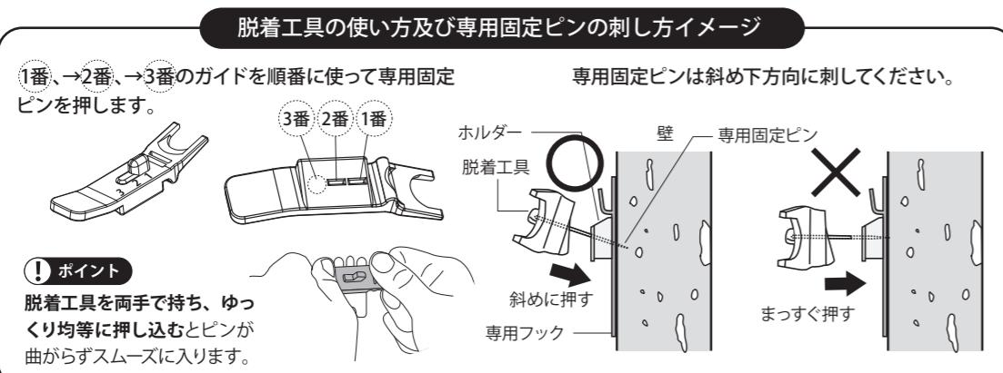
1 専用固定ピンをホルダー①の穴にはめて、脱着工具①のガイド(裏面)にピンをはめて、矢印の方向にゆっくり押し込みます。
