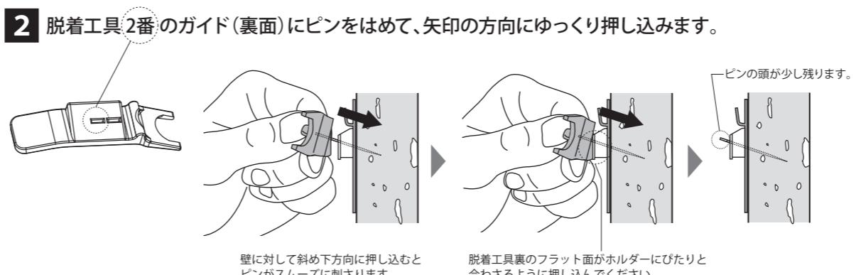
2 脱着工具②のガイド(裏面)にピンをはめて、矢印の方向にゆっくり押し込みます。
