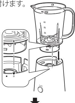
2. 本体を押さえ、ミキサーボトルの●印と本体の●印が合うまで、矢印の方向に回します。
