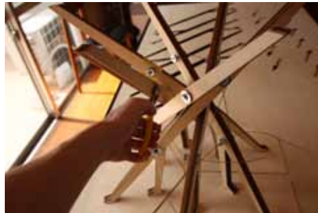
16. ワイヤー端部のボルトをペンチなどでまわしテンションをかける
