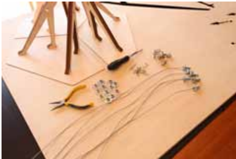
05. テンションシステム(ボルトにテンションを通した部品), Tナット, Tナットをとめる木ネジとプラスドライバ、ペンチを用意する
