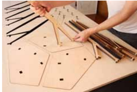
02. 天板は合板から取り外さず脚の部材を取り付ける
