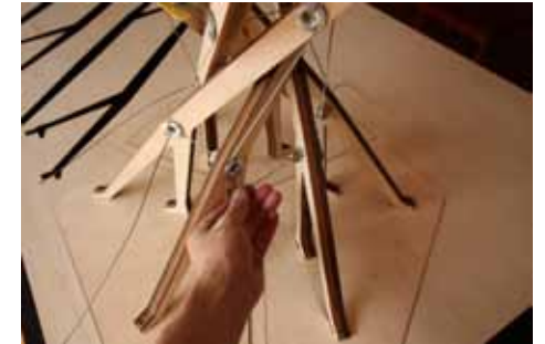
14. アラカワ技研の金具を取り付けそこにワイヤーを通す
