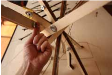
11. ゲージに取り付けた部品を外し、脚の部材にTナットを取り付ける。ワイヤーステム端部のボルトを取り付ける
