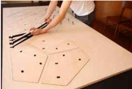
01. 型紙に沿って切り出した合板から脚の部材を取り出す
