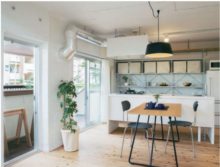
完全に壁から離れたアイランドキッチンも1階だからこその特徴です。床下を自由に使えるので、排水位置を気にせずキッチンを設置できました。
