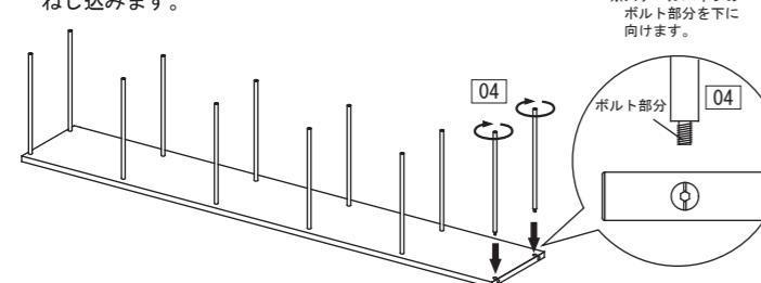
3 [01]側板の貫通穴と[04]スチールパイプの位置を合わせて[01]側板を乗せます。[01]側板をはさんで[04]スチールパイプに[05]ボルトをねじ込み、[06]六角レンチを使ってしっかりと締め込みます。※全てねじ込んだ後もう一度きつく締まっていることを確認してください。
