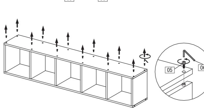
2 基本セット用[05]ボルトがねじ込んであった箇所に[04]スチールパイプを手でねじ込みます。
